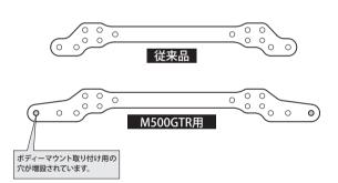
ボディーの固定位置をボディーのルーフ(天井)からではなくサイド部分で固定することが可能になります。低い位置でボディーを固定することにより、ロールモーメントが減り、安定した走行が可能になります。
