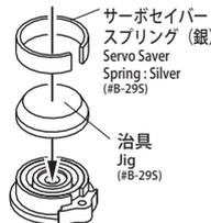
P部品についている治具をのせて、その上に0.6mm厚のサーボスプリング (銀) を取り付けます。
